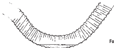
For megen kondensation i forsyningsslangen
