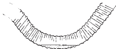
Condensation excessive dans le tuyau de distribution
