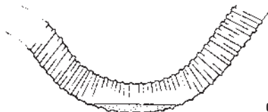
Eccessiva condensa nel tubo di somministrazione
