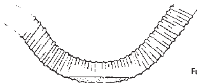
Alltför stor kondensering i tillförselslangen
