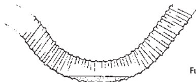
For mye kondensat i tilførselslange
