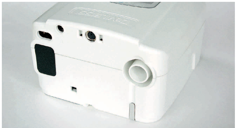
Rückseite mit Filter, Patientenschlauchanschluss und COM Anschluss
