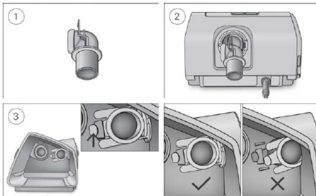
1. Halten Sie den Luftauslass so, dass die Dichtung nach links und der Clip nach vorne zeigt.
