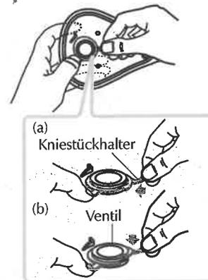
Um das Kniestück anzubringen, legen Sie eine Seite des Kniestückhalters in die Rille des Ventils. Halten Sie einen Flügel des Kniestückhalters niedergedrückt (a) und drücken Sie danach den anderen Flügel herunter, bis der Kniestückhalter vollständig einrastet (b).
