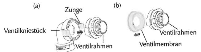
Kniestück vom Ventilrahmen abzunehmen (a). Nehmen Sie die Ventilmembran vorsichtig aus dem Ventilrahmen heraus (b).
