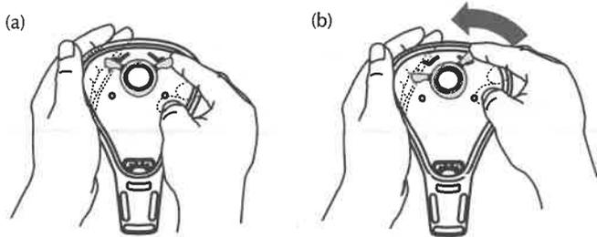
Drücken Sie den rechten Flügel des Kniestückhalters von der Innenseite des Maskenhalters (a) über die rechte L-förmige Leiste am Maskenhalter (b).
