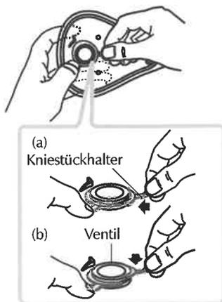
Um den Kniestückhalter abzunehmen, halten Sie einen Flügel des Kniestückhalters herunter. Ziehen Sie den anderen Flügel kräftig heraus (a) und dann nach oben (b) über das Ventil. Nehmen Sie den Kniestückhalter und das Ventil vom Maskenhalter ab.
