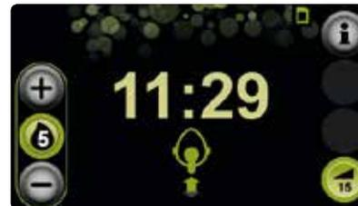
Bildschirm im Zustand „Standby, Befeuchter in Betrieb“ (vorheizen)
